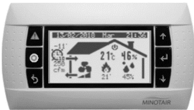
Figure 34 – On active la minuterie virtuelle de salle de bains en appuyant sur ↵ et Ⓢ.
